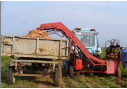
Механизированная уборка моркови столовой комбайном МНТ-1М
